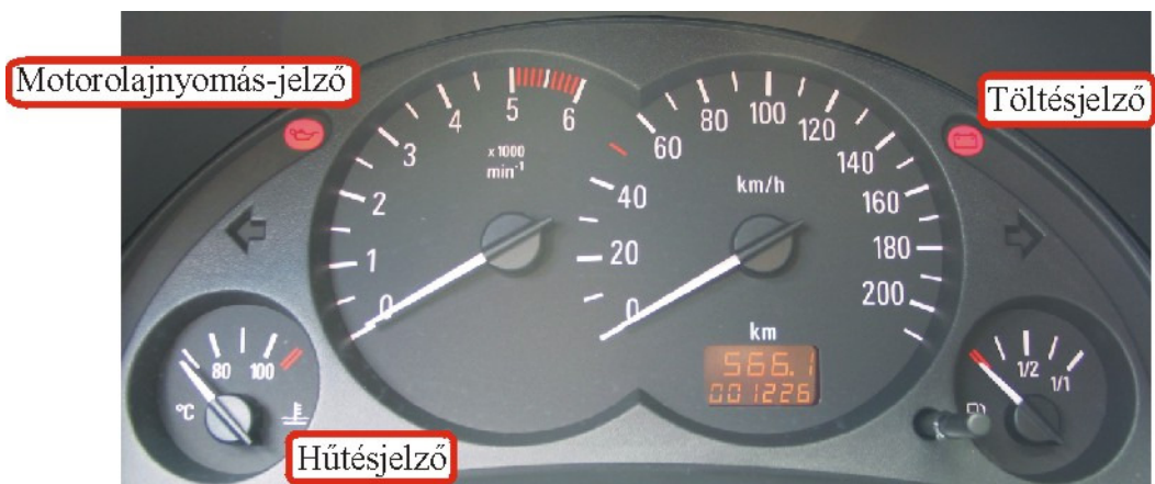
10. ábra A motorolajnyomást, a töltést és a hűtést visszajelző műszerek
