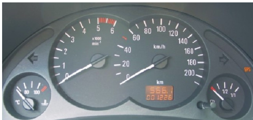
2. ábra Az elektromos kormány szervó hibájára figyelmeztető lámpa (EPS)
